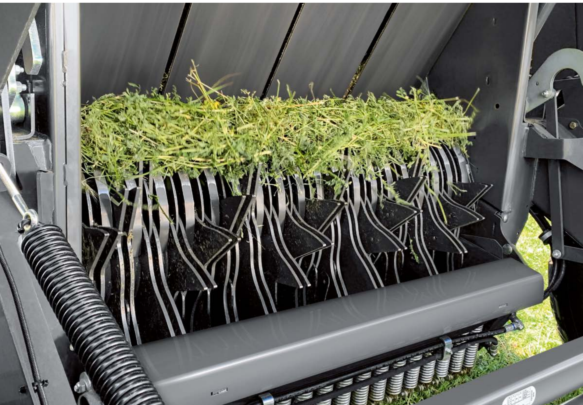
1 Подающий ротор подает растительную массу в камеру прессования и инициирует начало прессования тюка.
